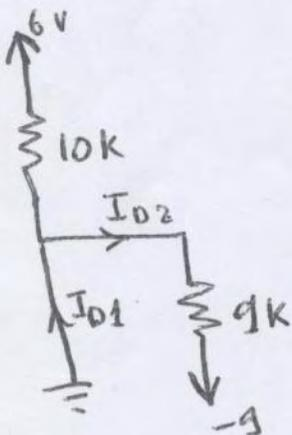
$$\text{KVL: } \Rightarrow 1 I_{D2} - 9 = 0 \Rightarrow I_{D2} = 9 \text{ mA} > 0 \Rightarrow D_2 \text{ on}$$
