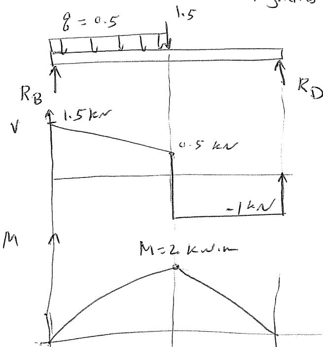
$$\Rightarrow V_{max} = 1.5 \quad \begin{cases} x < 2 \text{ m} \\ x > 2 \text{ m} \end{cases}$$
