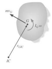
$$H_{IC} = r_{GIC}m\omega r_{GIC} + I_G\omega$$
