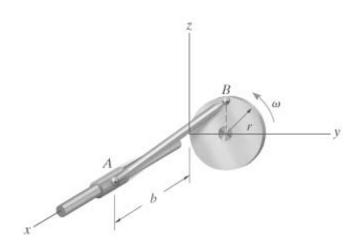
$$\begin{pmatrix} 0 \\ 0 \\ -\omega^2 r \end{pmatrix} + \begin{pmatrix} \alpha_x \\ \alpha_y \\ \alpha_z \end{pmatrix} \times \begin{pmatrix} b \\ -r \\ -r \end{pmatrix} + \begin{pmatrix} \omega_x \\ \omega_y \\ \omega_z \end{pmatrix} \times \begin{bmatrix} \omega_x \\ \omega_y \\ \omega_z \end{pmatrix} \times \begin{bmatrix} b \\ -r \\ -r \end{bmatrix} = \begin{pmatrix} a_A \\ 0 \\ 0 \end{pmatrix}$$
